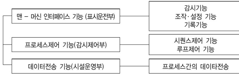
[그림 6.3.7] 감시제어시스템 기능 분류
