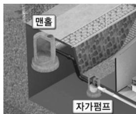
[그림 2.13.9] 자가배수 펌프시설 설치 개념도
